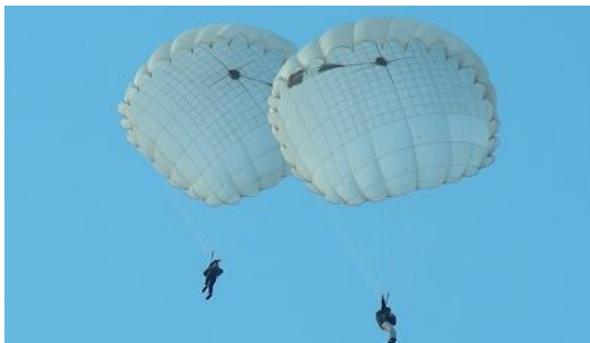
D-5 to niezawodny typ spadochronu z systemem dwustopniowego otwarcia
